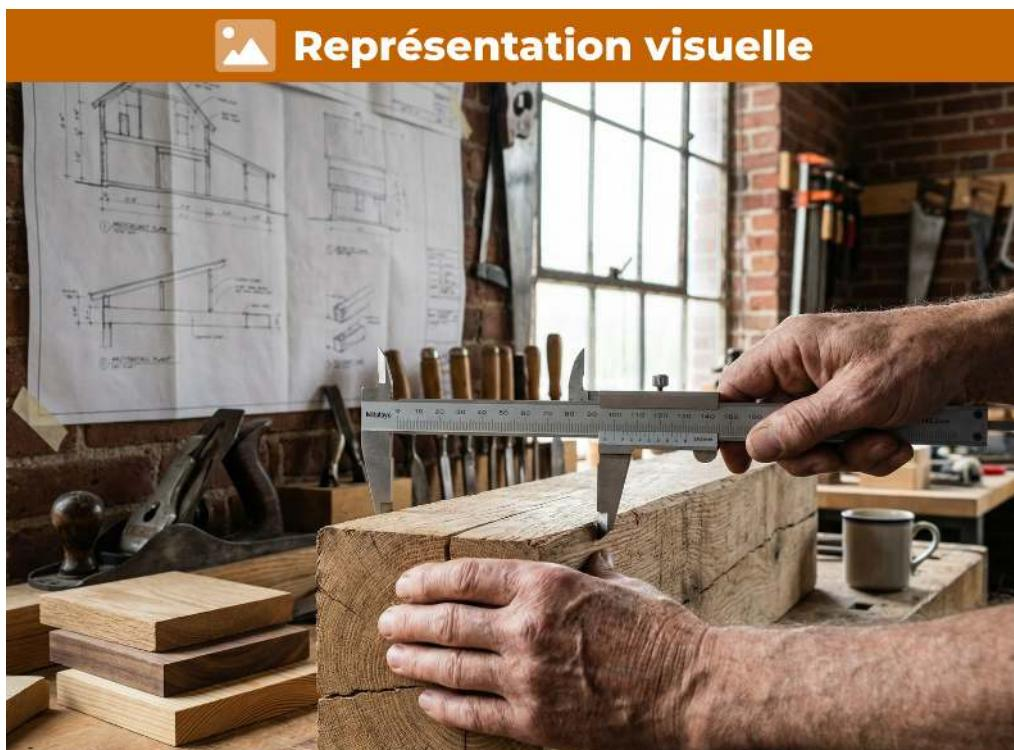
*Mesurer avec un pied à coulisse assure une tolérance de  $\pm 0,5$  mm sur les dimensions*
