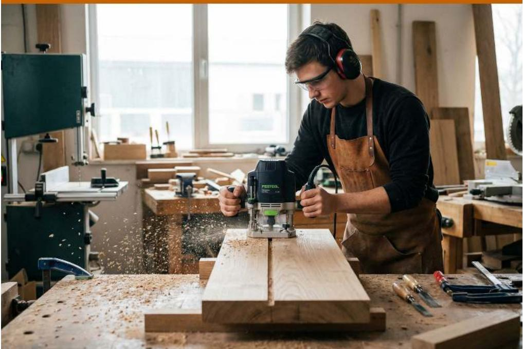
Utiliser une défonceuse permet d'obtenir des rainures précises pour les assemblages
